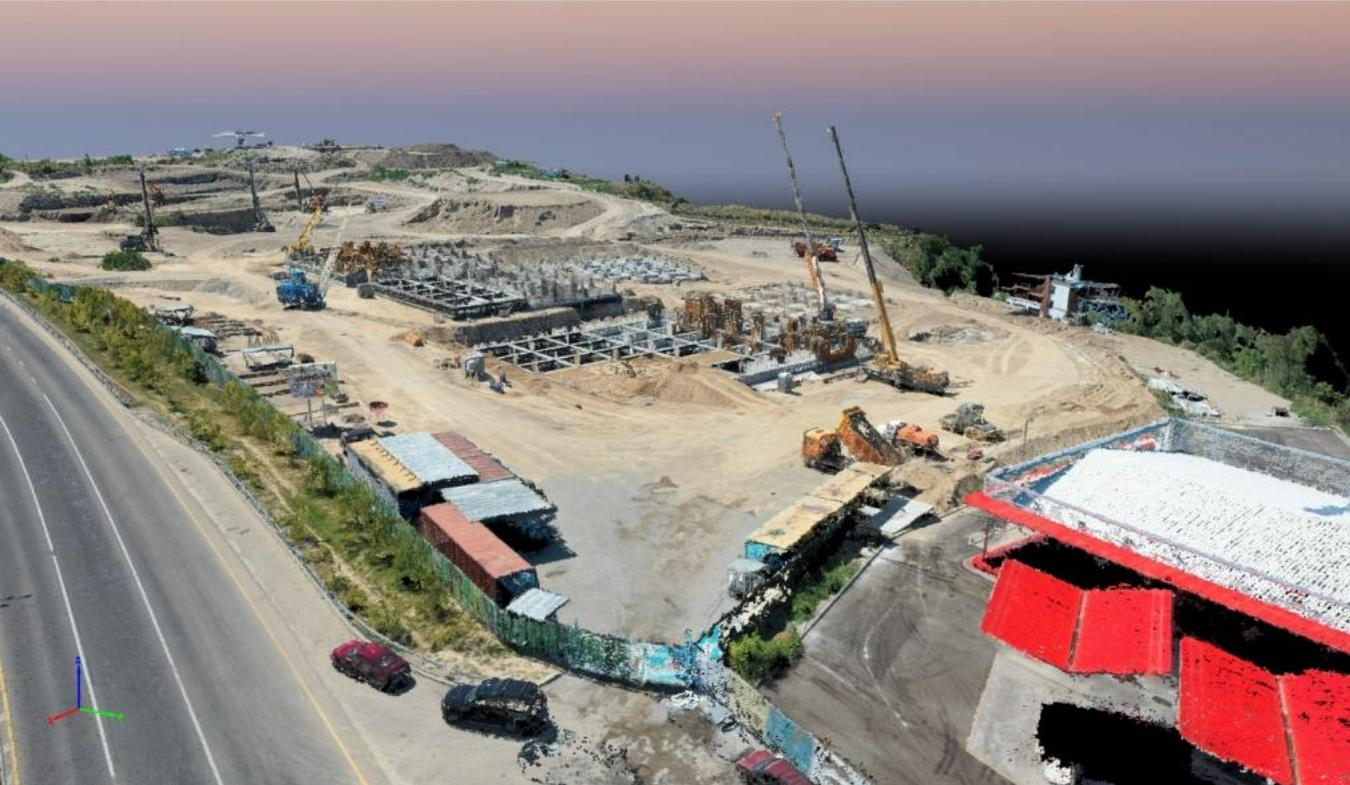
Плотное облако точек, отображающее строительную технику, здания и сооружения, ограждения, растительность и объекты строительства в мельчайших деталях (арматура, опалубка и т.д.).
